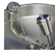
ANSI Z358.1規格の洗眼器要求、1.5Liter/min以上に対応する洗眼ヘッドです。フローコントロールゴムが内蔵されており、運転圧力0.2MPa以上で、流量を約10Liter/minの一定流量を保ちます。
