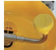
ANSI Z358.1規格の洗眼/顔器要求、11.4Liter/min以上に対応する洗眼/顔ヘッドです。フローコントロールゴムが内蔵されており、運転圧力0.2MPa以上で、流量を約11.4Liter/minの一定流量を保ちます。
