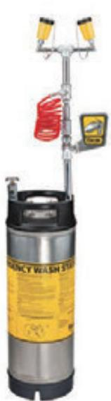
毎分1.5Literの水を数分間供給可能なポータブル洗眼器です。水をタンクに注入し、コンプレッサーエア(約0.6MPa)を加圧しておいて待機させておきます。タンクはステンレス製のため、耐候性、耐食性に優れています。
